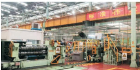
S2 : 冷轧1550纵剪生产线
